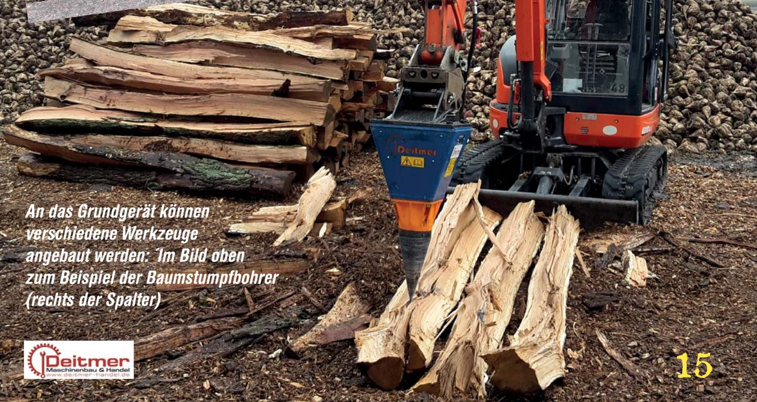
*An das Grundgerät können verschiedene Werkzeuge angebaut werden: Im Bild oben zum Beispiel der Baumstumpfbohrer (rechts der Spalter)*
